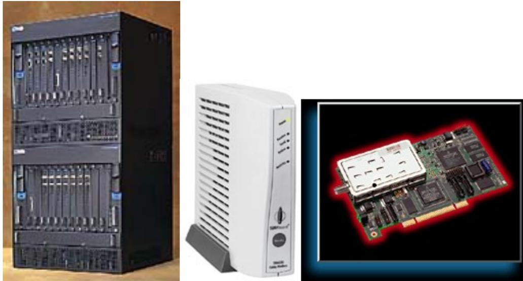
(圖左為頭端設備；圖中為外接式纜線數據機；圖右為纜線數據機插卡)
