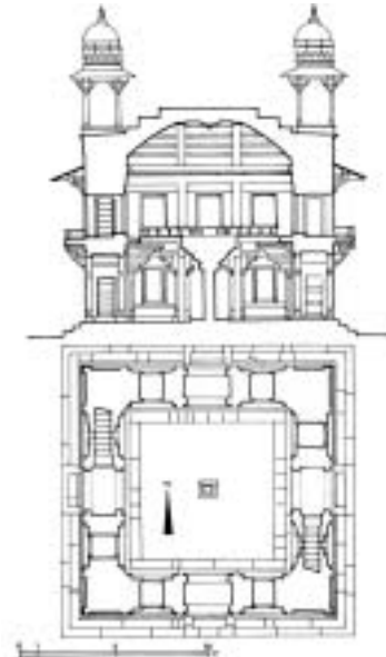
圖十六：法第普希克利 私人寓所剖面與平面 圖版來源：《伊斯蘭建築》圖 335
